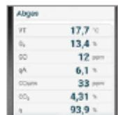
Настраиваемый дисплей Семистрочный дисплей с четким меню. Прост в использовании и удобен для чтения. Дисплей настраивается с помощью приложения Testo Smart.
