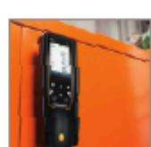
Фиксация Встроенные магниты для удобной фиксации на горелке.
