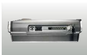
Разъем для подключения Мини-USB кабеля или SD-карты
