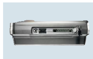
Подключение кабеля Mini USB и SD карты
